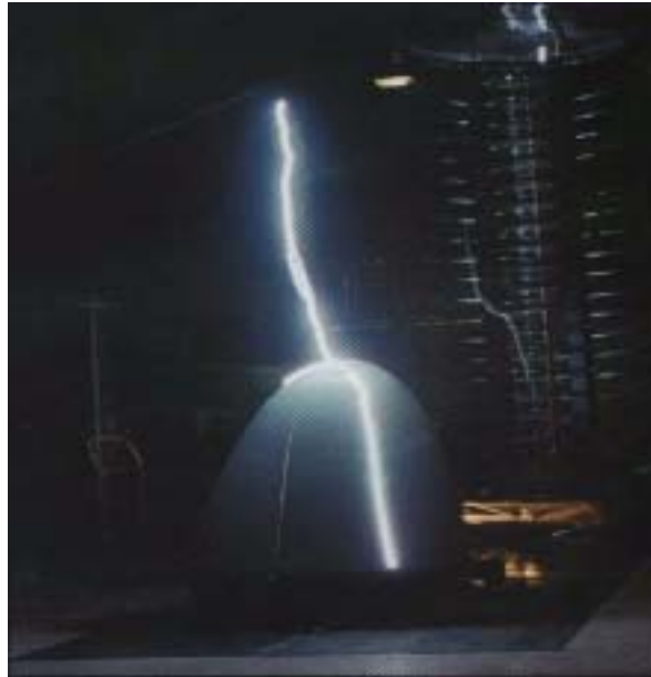
&lt;그림 2-6&gt; 레이돔 직접뢰 시험
