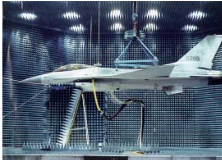
&lt;그림 2-3&gt; Anechoic Chamber에서 시험 중인 F-16 전투기
